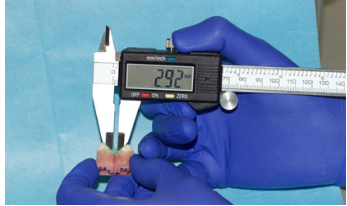
Resim 1. Kontak genişliklerinin elektronik kumpas ile ölçülmesi.
