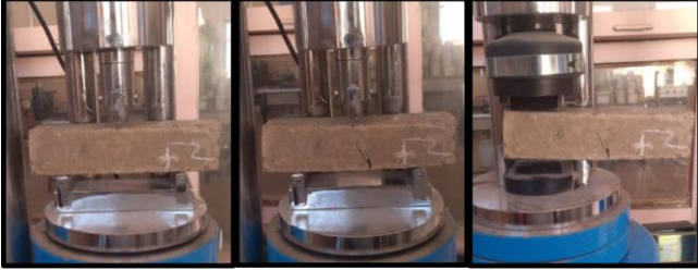
Şekil 3: Harçlar üzerinde yapılan eğilme ve basınç deneyleri.
