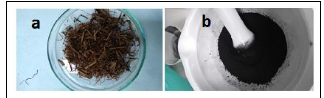
Şekil 5(a): Çay atıkları. (b): Çay atıkları biyokömürü.
