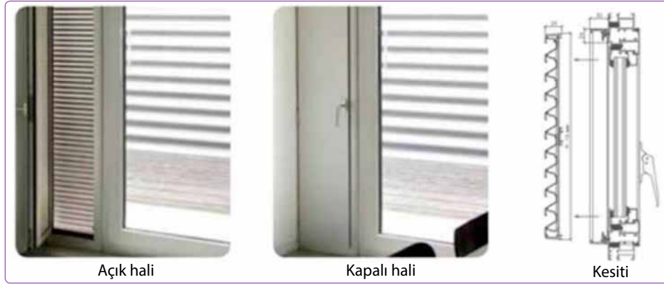
Şekil 4. Koruma kapağı ile uygulanmış, gece havalandırmasında da kullanılacak havalandırma menfezleri. 37
