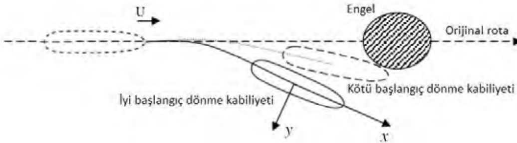
Şekil 3. 10^\circ/10^\circ zigzag testi ile belirlenen başlangıç dönme kabiliyeti (Zaojian, 2006).
